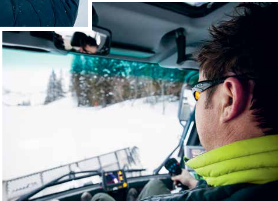
Bis auf den Zentimeter genau kann die Pistenraupe den Schnee präparieren. Möglich macht das die Vermessung mit Satelliten
