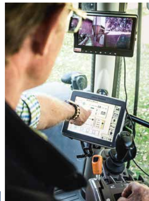
Alles im Blick: Auf dem Green-Star-3-Display des Traktors werden Ladezustand der Batterie, Verbrauch oder aktuelle Rekuperation angezeigt
