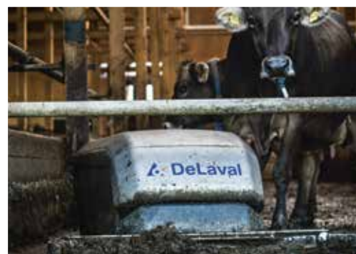
Vollautomatisierter Biobauernhof: Der Spaltenschieber sorgt für sauberen Fußboden – wichtig für gesunde Klauen
