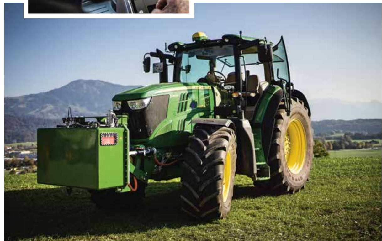
Die Kombination aus dem 210-PS-Dieselmotor und dem 20-kW-E-Antrieb sorgt für satte Power
